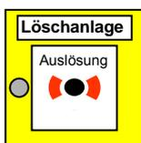
Handsteuereinrichtung für (Gas-)Löschanlagen
