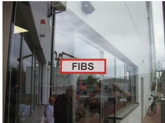
Bild 10 Bei Neuanlagen wird zur Kennzeichnung des Feuerwehrhauptzuganges zur Erstinformationsstelle das Hinweisschild nach DIN 4066 D1 mit der Aufschrift „FIBS“ verwendet. Bestandsanlagen müssen sukzessiv umgekennzeichnet werden.
